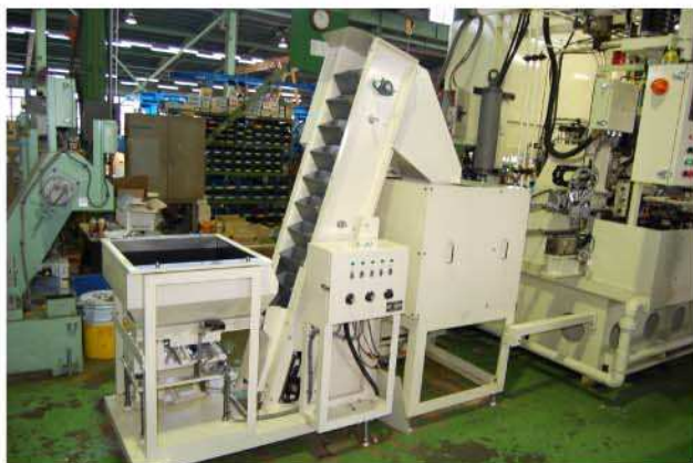
素材投入バケット、エレベーター
