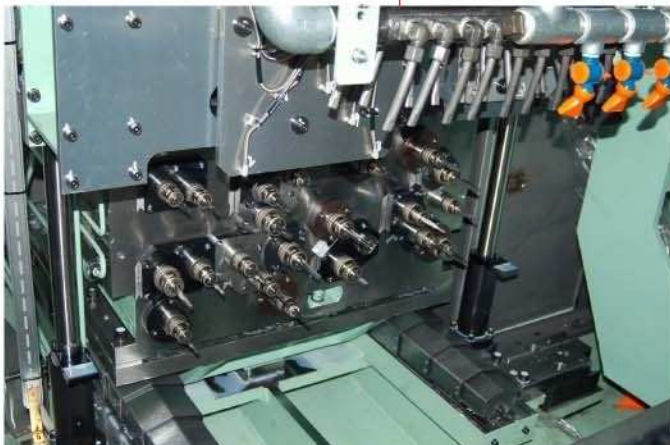
3 ST-R フロント側面加工
