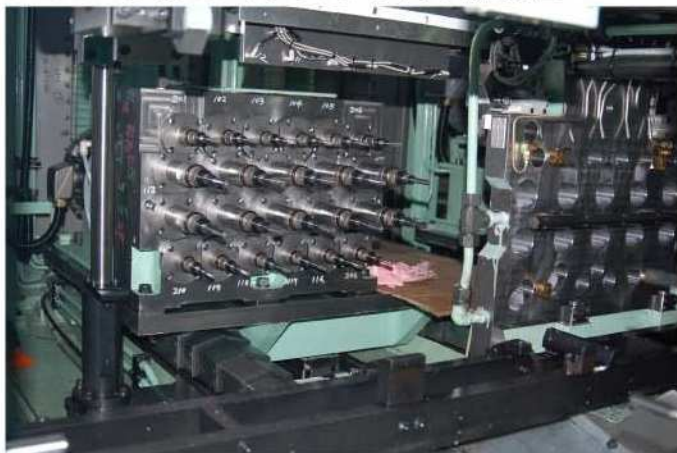
7 ST-R オイルパン、クランクキャップ側面加工
