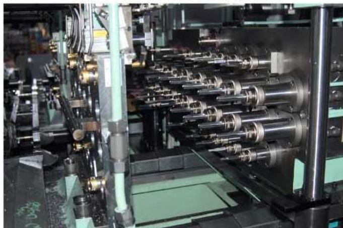
6 ST-R オイルパン、クランクキャップ側面加工
