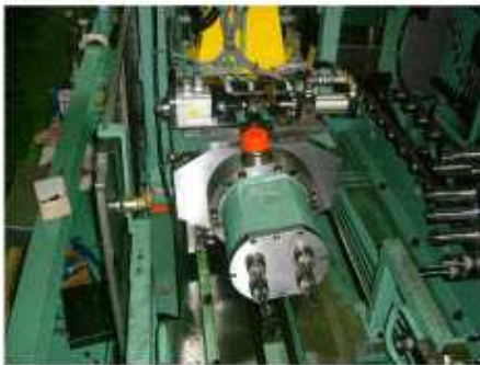
▲左側ドリルヘッド
