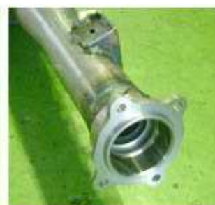
▲エンドフランジ部
