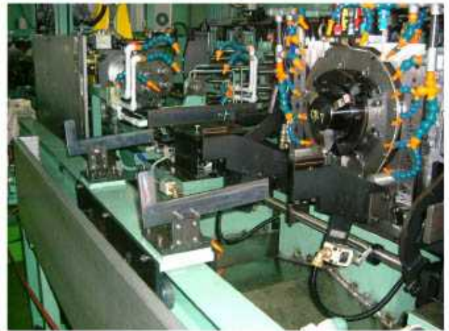
▲治具(右)及び加工物搬送用モノレール(左)
